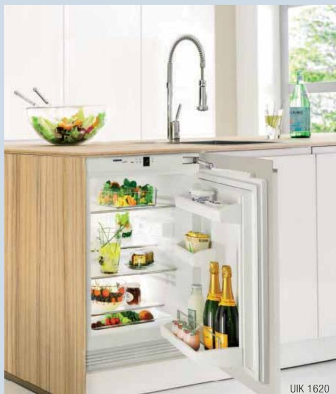
Для создания единого стиля интерьера возможна установка холодильника или морозильника в готовую нишу для встраивания под существующую столешницу. Дверь ниши крепится к двери холодильника при помощи системы door on door. В процессе работы теплообмен происходит через цоколь, поэтому не нужно предусматривать вентиляционную решетку в рабочей поверхности. При помощи специальной цокольной панели Varío высоту и глубину можно подогнать под параметры ниши для встраивания.
