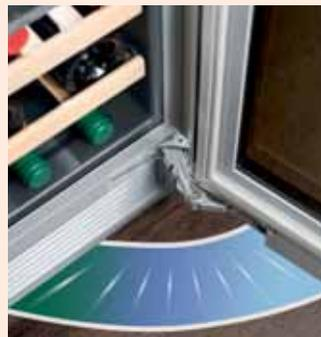
Система **SoftSystem** обеспечивает исключительно мягкое и плавное закрывание двери, не допуская вибрации, которая отрицательно сказывается на качестве вина. Дверь закрывается автоматически, если угол открытия менее 30°.
